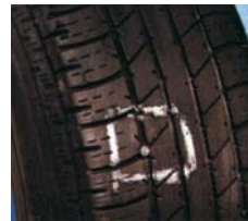
1. Снять покрывку и отметить канал прокола.
