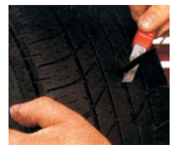
9. После монтажа и накачки колеса срезать хвостовик заплатки (не вытягивая).
