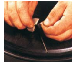
6. Снять защитную плёнку, не прикасаясь к поверхности заплатки.
