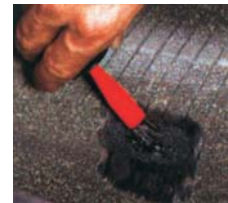
5. Заполнить канал прокола каплей раствора. Распределить раствор по отшлифованной поверхности. Дать просохнуть 5 минут.
