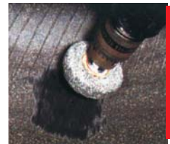
3. Отшлифовать без нажатия (устранить возможные канавки). Макс. скорость вращения 5000 об./мин.
