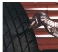
7. Вытянуть зонд снаружи, чтобы диск заплатки ровно прилегал к внутренней стороне шины.
