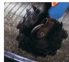
8. Роликом раскатать заплатку движениями от центра наружу.
