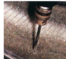
2. Изменить повреждённый участок. Рассверлить канал прокола с внутренней стороны.
