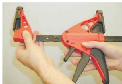
4 - ... и присоединить на другую сторону направляющей планки
